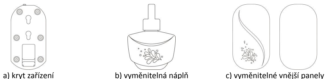
Obr. 1. Elektrický osvěžovač vzduchu – konstrukce
